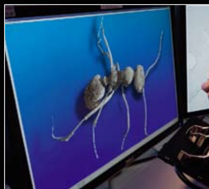
3. I en computer omdannes de mange røntgenbilleder til et imponerende detaljeret 3-d-billede af det insekt, som har været skjult.
