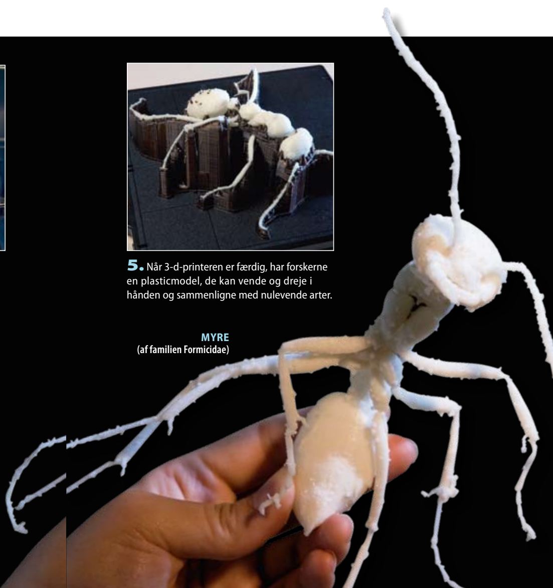
4. Ud fra computermodellen kan forskerne vha. en særlig teknik printe en stor plastic-model af insektet. Den bygges op lag for lag.
